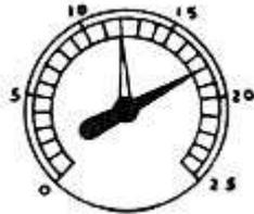
n°6. Uma válvula carbonizada causa uma queda brusca de vários pontos toda vez que aquele determinado cilindro opera.
