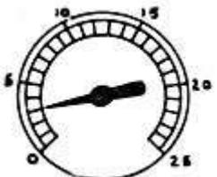
n°9. Uma leitura estável abaixo de 5 indica vazamento na tubulação (de vácuo), ou juntas do pé do carburador. Veja também o aquecimento do pé do carburador.
