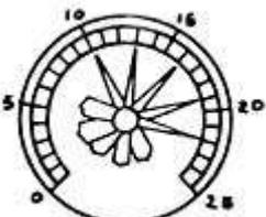
n°13. Grandes variações da agulha quando o motor é acelerado indica motor molas de válvulas fracas ou quebradas
