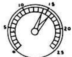
n°12. Quando a agulha oscila entre 14 e 16 geralmente indica pequena abertura na velas ou ponto de ignição não sincronizado.
