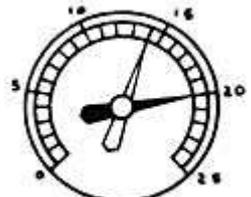
n°16. Se a leitura normal é 20 pol. E a leitura caiu para aprox. 14, o ponto de ignição deve ser checado, e provavelmente atrasado.
