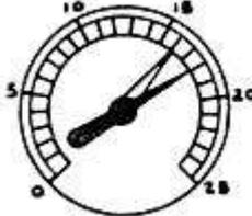
n°7. Válvulas vazando também podem fazer a leitura cair 3 ou 4 pontos, toda vez que a válvula abre.
