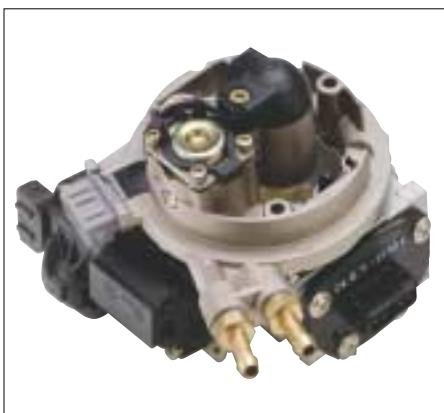
Também chamado “corpo de borboleta” engloba vários componentes e sensores. Montado no coletor de admissão, ele alimenta os cilindros do motor. Na unidade central de injeção encontram-se a válvula de injeção, o potenciómetro da borboleta, o atuador de marcha lenta, o regulador de pressão e o sensor de temperatura do ar.
