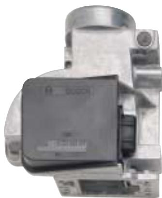
A medição da quantidade de ar admitida se baseia na medição da força produzida pelo fluxo de ar aspirado, que atua sobre a palheta sensora do medidor, contra a força de uma mola. Um potenciômetro transforma as diversas posições da palheta sensora em uma tensão elétrica, que é enviada como sinal para a unidade de comando.
