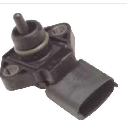
Os sensores de pressão possuem diferentes aplicações. Medem a pressão absoluta no tubo de aspiração (coletores) e informam à unidade de comando em que condições de aspiração e pressão o motor está funcionando, para receber o volume exato de combustível.
