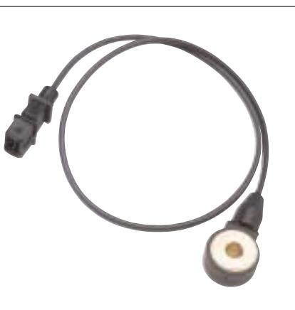
Instalado no bloco do motor, o sensor de detonação converte as vibrações do motor em sinais elétricos. Estes sinais permitem que o motor funcione com o ponto de ignição o mais adiantado possível, conseguindo maior potência sem prejuízo para o motor.
