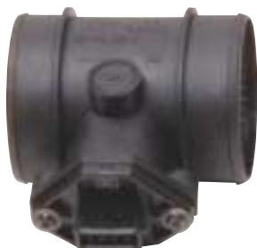
O medidor de massa de ar está instalado entre o filtro de ar e a borboleta de aceleração e tem a função de medir a corrente de ar aspirada. Através dessa informação, a unidade de comando calculará o exato volume de combustível para as diferentes condições de funcionamento do motor.
