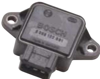
O potenciômetro da borboleta de aceleração está fixado no corpo da borboleta, acionado através do eixo da borboleta de aceleração. Ao contrário do sistema Le-Jetronic, o potenciômetro informa para a unidade de comando todas as posições da borboleta de aceleração. Desta maneira, a unidade de comando obtém informações mais precisas sobre os diferentes regimes de funcionamento do motor, utilizando-as para influenciar também na quantidade de combustível pulverizado, como no sistema Le Jetronic.
