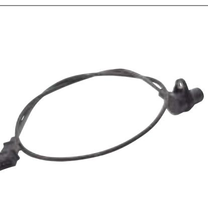
Na polia do motor está montada uma roda dentada magnética com marca de referência. A unidade de comando calcula a posição do virabrequim e o número de rotações do motor, originando o momento correto da faísca e da injeção de combustível.
